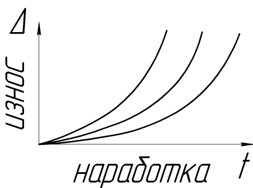
Рис. 2.1. Зависимость износа детали от наработки
